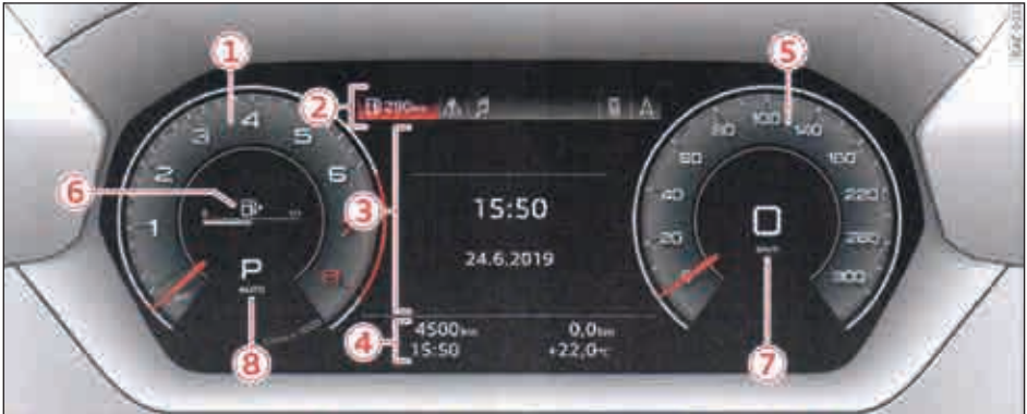
איור 2 סקירה כללית של לוח מחוונים משולב פלוס (Audi virtual cockpit plus)
