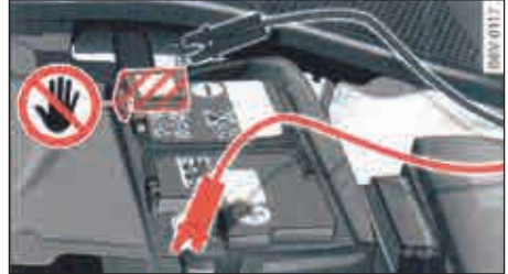
الصورة 176 غطاء المحرك: توصيلات بكابلات التشغيل أو بجهاز الشحن
