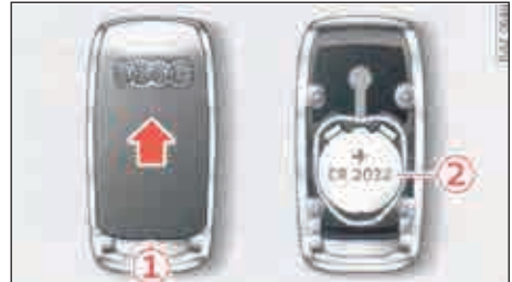
الصورة 78 جهاز التحكم عن بعد: تبديل البطاريات
