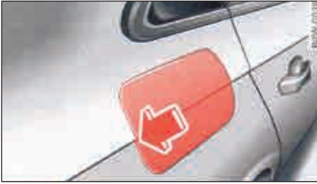
الصورة 147 الجهة اليمنى الخلفية من السيارة: فتح غطاء خزان الوقود
