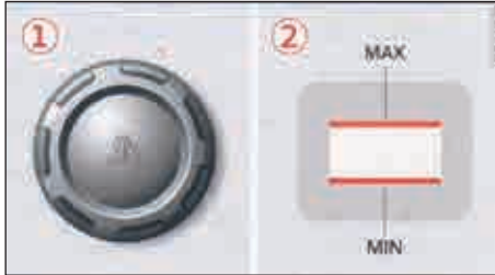
איור 157 תא המנוע: מכל התפשטות של נוזל הקירור: ① מכסה: ② סימונים
