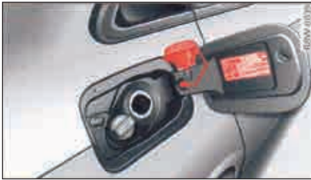
الصورة 148 باب خزان الوقود مع غطاء وقود متصل
