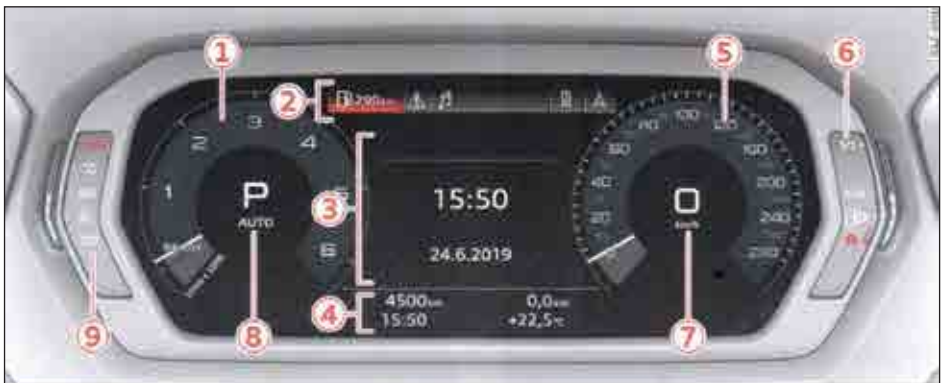
איור 3 סקירת לוח המחוונים המשולב הדיגיטלי או Audi virtual cockpit
