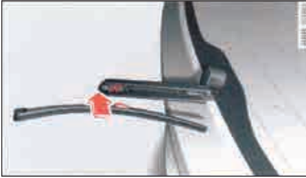
الصورة 45 ماسحة الزجاج الخلفي: تركيب شفرة ماسحة زجاج السيارة
