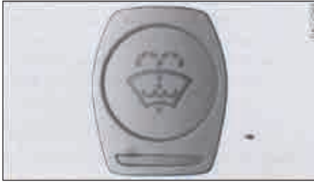
الصورة 160 غطاء المحرك: غطاء خزان سائل الرشاش
