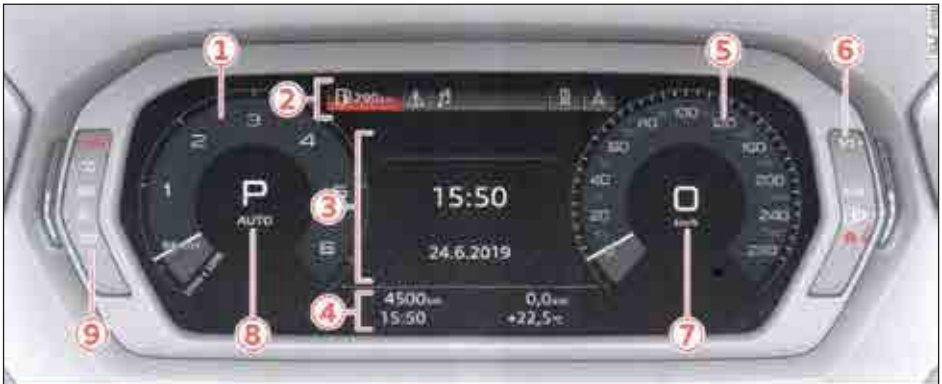
الصورة 3 إجراء فحص للوحة المؤشرات المدمجة الرقمية أو Audi virtual cockpit
