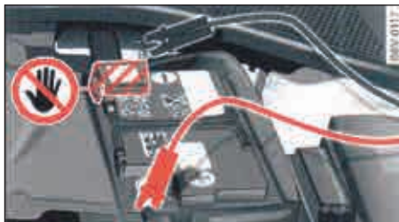
איור 176 תא מנוע: חיבורים לכבלי התנעה או למכשיר הטענה
