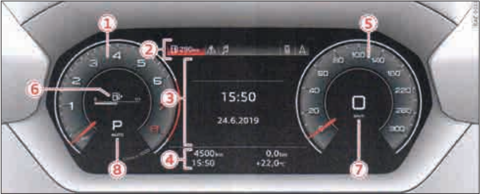
الصورة 2 فحص شامل للوحة المؤشرات المدمجة بولس (Audi virtual cockpit plus)
